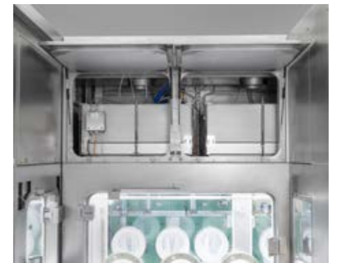
HEPA filter fan
