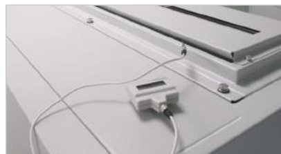
Messung der Temperatur der Luftaustrittsströmung
