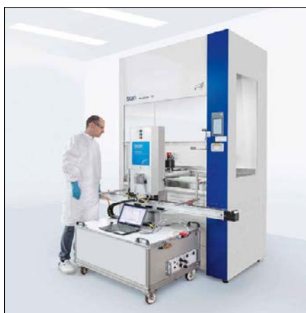
Abb. 1: Kann für Energieeinsparungen sorgen und kommt ohne das klimaschädliche Tracergas «Schwefelhexafluorid» aus: Das validierte Alternativ-Testsystem für Laborabzüge «SKAN contest» im Einsatz. (Bild: Skan)
