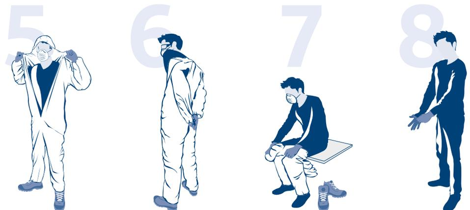
\*Verwenden Sie für Tyvek® 600 Plus und Tyvek® 800 J selbstklebendes Band zum Abdichten der Reißverschluss- und Kinnabdeckungen.
